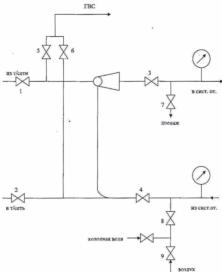
*Схема промывки системы отопления.*
